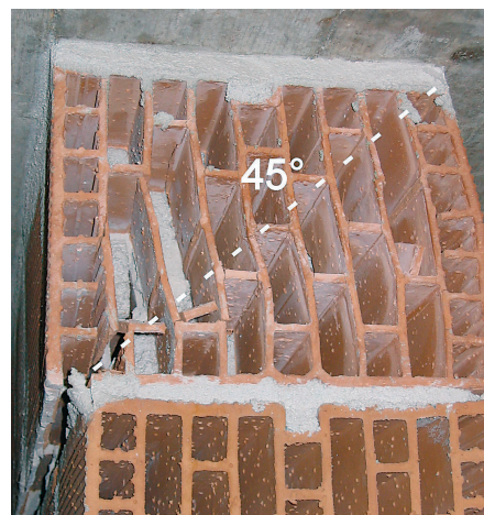
4. Rottura del corso inferiore nel campione FOA1 ( sinistra ); deformazione e rottura del corso superiore nel campione FOB2 ( destra ).
