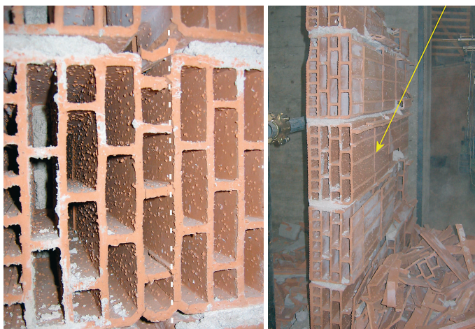
5. Lesione verticale in sezione: particolare (sinistra) e dopo la demolizione del campione FOA 3 (destra).
